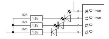
Ich habe drei LEDs an Pins 11, 12 und 13 gehängt. Sie werden gegen GND geschaltet, leuchten also, wenn die Ausgänge auf HIGH gelegt werden.
