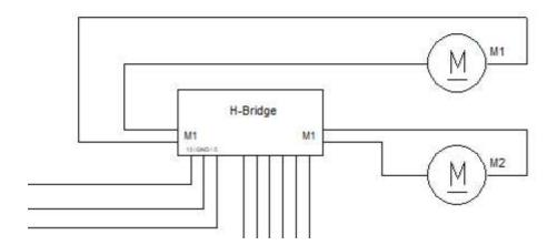
Neben den Spannungsklemmen sieht man 3 x 2 Stifte, an die der Arduino angeschlossen wird.
