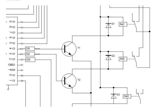
Die Relais können nicht direkt an den Arduino gelegt werden, daher ist ein klassischer NPN Transistor dazwischen. Der Emitter liegt jeweils an GND.
