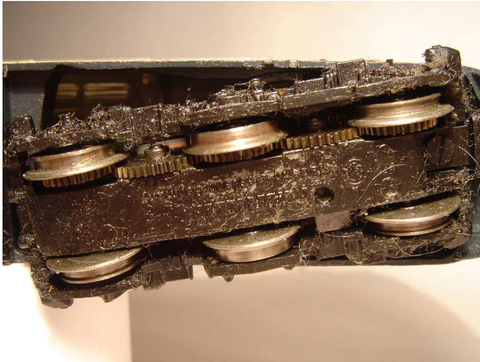
Bild 1-4 Bodenansicht der E 103 • Rost, • Verhartetes Fett • Fehlende Treibreifen
