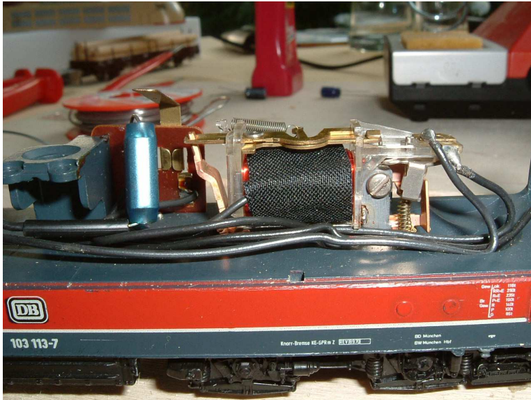
Bild 2 Der alte Umschalter ist freigelegt und wird als erstes ausgebaut
