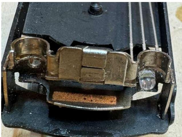
In das Blech wurden zwei Löcher von 4 mm Durchmesser gebohrt, in die die LED passen.
