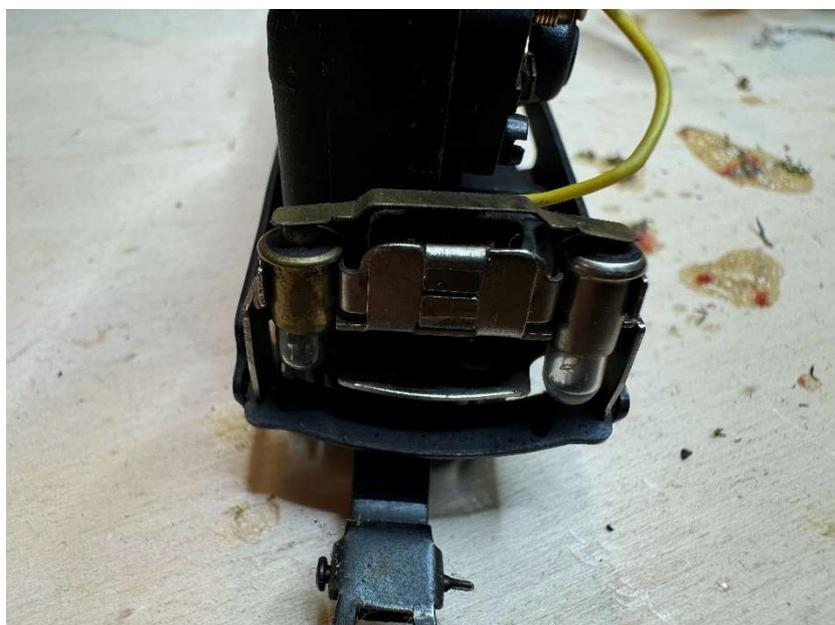
Dann ging es an die Beleuchtung. Es sind im Auslieferungszustand Glühlampen in Klemmhalterungen eingesetzt. Da vorn mehr Platz ist als hinten hinter dem Motor wurde die ganze Einheit mit dem Dremel gelöst.
