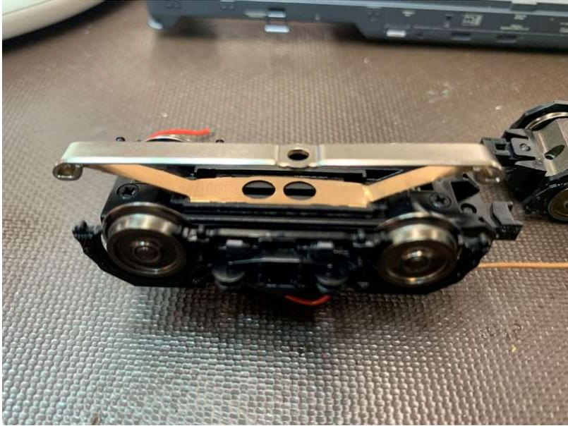
Der Schleifer wird montiert.
