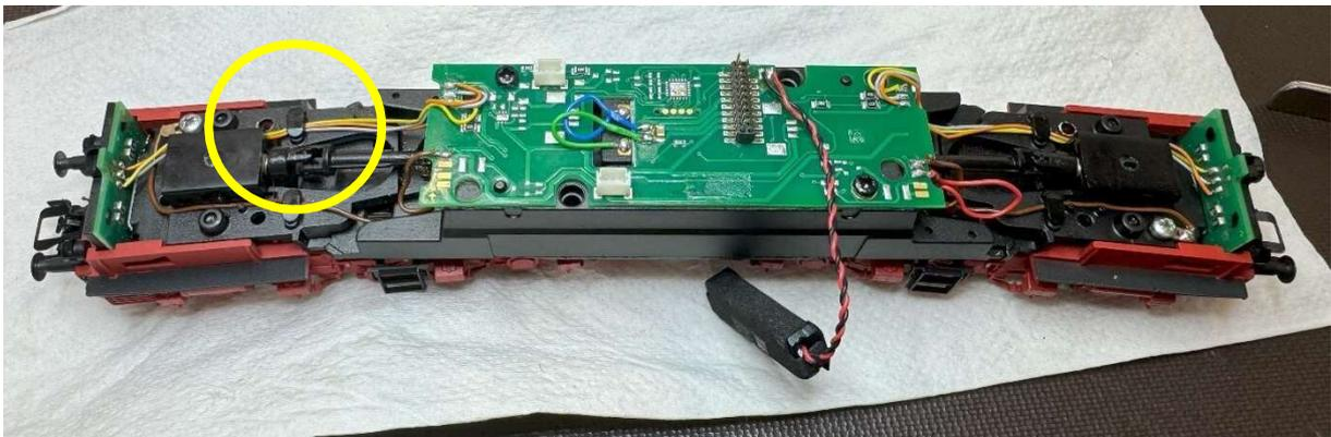
Die Kabel werden ordentlich verlegt und mit Kabelhaltern fixiert.
