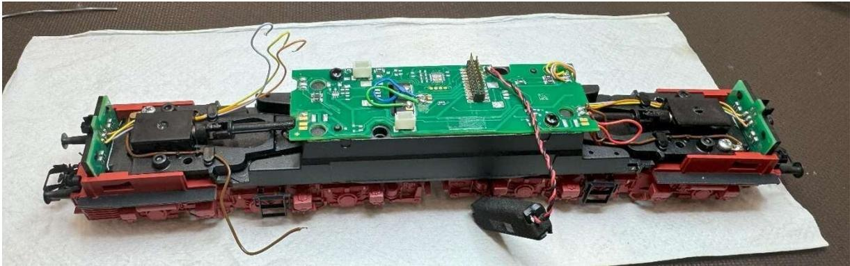
Der Lautsprecher kommt an seine beiden Lötstützpunkte auf der Platine.
