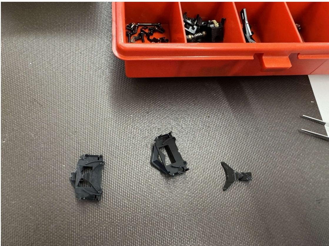
Kupplungsdeichsel und Schienenräumer werden bereitgelegt und mit dem Gussträger verbunden.
