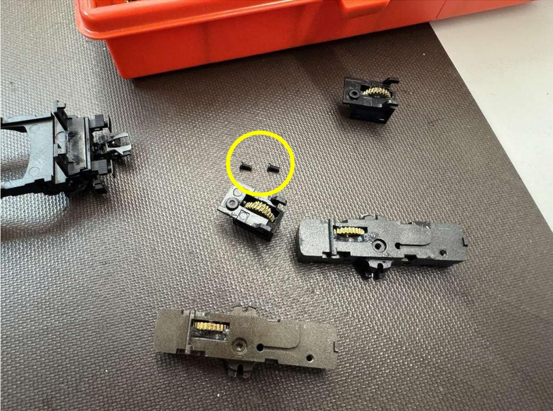
Traggestell und Getriebeaufsatz sind an der Reihe. Die Befestigung erfolgt mit je einer Senkkopfschraube.
