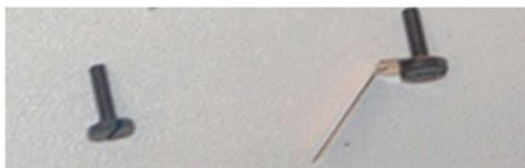
Die Befestigung erfolgt von unten mit vier Schrauben. Eine Schraube trägt die Kontaktfeder.
