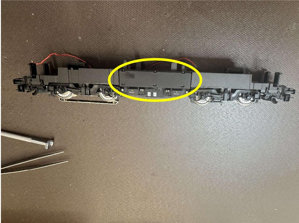
So sieht der Träger von der Seite aus. Das Schleiferkabel (rot) schaut oben links heraus.
