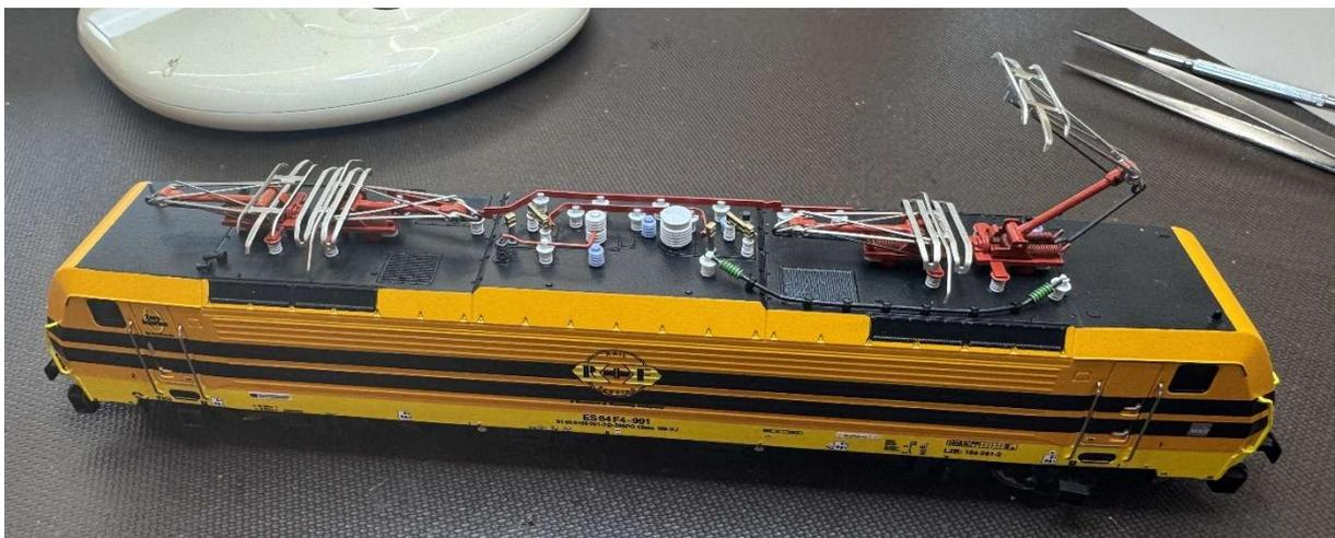
Das Gehäuse wird von unten mit zwei Absatzschrauben befestigt.
