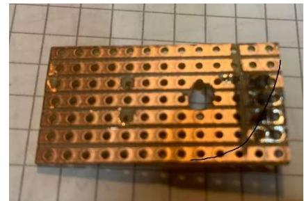
Vor dem Einbau löte ich die beiden Vorwiderstände über die Leiterbahnunterbrechungen und **messe nach!!** Über die Widerstände und zwischen den Leiterbahnen! Es darf keine Verbindung sein. Die kann man nämlich sehr leicht "herstellen", z.B. Lötzinnklecks. Durch die Rundung kann die Platine angeschraubt werden und leicht um 90 Grad nach oben geschwenkt werden.
