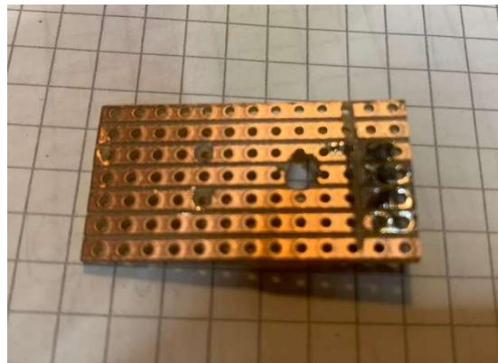
Die "Platine" verdient ihren Namen nicht so richtig. Es ist einfach ein Stückchen Streifenplatine, in das ich ein Loch für die Schraube des alten Umschalters gebohrt habe. Auf der Rückseite ist die Leiterbahnunterbrechung für die beiden Vorwiderstände zu sehen. Die Unterbrechung ist mit dem Bohrer schnell gemacht, aber – wie man sieht – nicht vollständig. Also hätte die LED den direkten Weg in die ewigen Jagdgründe genommen.
