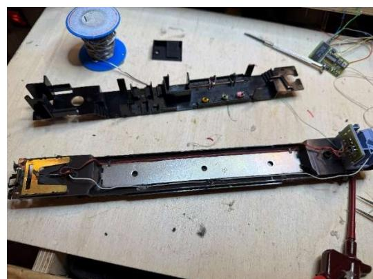
Die Litze wird von der Kupplung wird im Steuerwagen nach hinten geführt.
