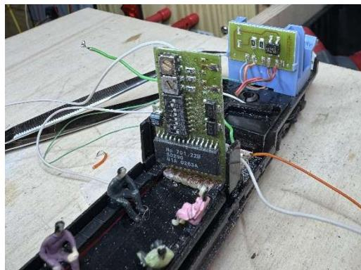
Waagerecht liegt eine Streifenplatine zur Aufnahme der Anschlüsse. Dort ist auch der Funktionsinverter.
